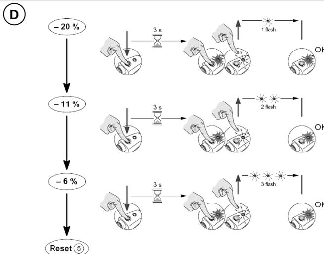
**Nota:** Pour programmer un nouveau seuil de sous -vitesse ou une nouvelle vitesse de rotation, veuillez reprendre toutes les étapes de la programmation en commençant par réaliser un reset.
